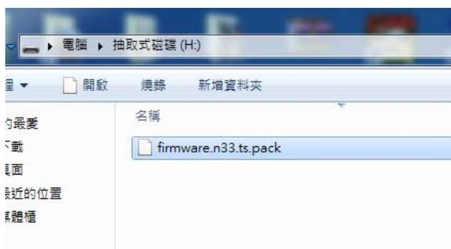
4. 行車紀錄器於送電前先插入 SD 卡,送電,開機後會出現 UPDATE 更新圖示,即表示進入韌體更新模式·更新完成後會自動重開機(更新過程中請勿將電源斷電,以免造成更新失敗)
